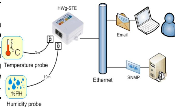
Удаленно можно получать данные о температуре и влажности в данный момент, просмотреть график изменения параметров, и настроить отправку уведомлений (E-mail, SMS) в случае выхода температуры или влажности за пределы нужного диапазона. Используя комплект Hwg-STE-PoE можно выполнить монтаж устройств в минимальные сроки благодаря питанию устройства через Ethernet. К этому разделу относятся прибор Hwg-STE, Poseidon2, Ares. Дополнив данную систему устройствами из
