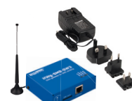
HWg-SMS-GW3 Set СМС-шлюз для прозвона и СМС-уведомлений через локальную сеть. Включает антенну и адаптер питания.
