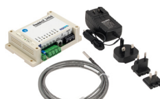
Poseidon2 3468 TSet включает в себя датчик температуры и адаптер питания.
